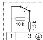
Öffnerkontakt **mit Wiedereinschaltperre** und Widerstandskombination, für **Maximaldrucküberwachung** Gehäuse mit Kunststoff beschichtet (Chemieausführung).
