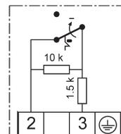
Öffnerkontakt mit Widerstandskombination, für **Maximaldrucküberwachung**, vergoldete Kontakte, Gehäuse mit Kunststoff beschichtet (Chemieausführung).
