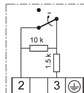
Öffnerkontakt **mit Wiedereinschaltperre** und **ZF575** Widerstandskombination, für **Minimaldrucküberwachung** Gehäuse mit Kunststoff beschichtet (Chemieausführung)
