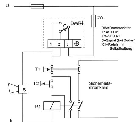
Bei Verwendung der oben dargestellten Verriegelungsschaltung werden die Anforderungen nach DIN 57 116/VDE 0116 erfüllt, wenn die elektrischen Betriebsmittel (wie Schütze oder Relais) der externen Verriegelungsschaltung VDE 0660 bzw. VDE 0435 entsprechen.
