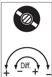
Bei Druckschaltern der Bau-reihe DWAMV und DWR...-203 ist die Wirkungsrichtung der Differenzschraube umgekehrt.
