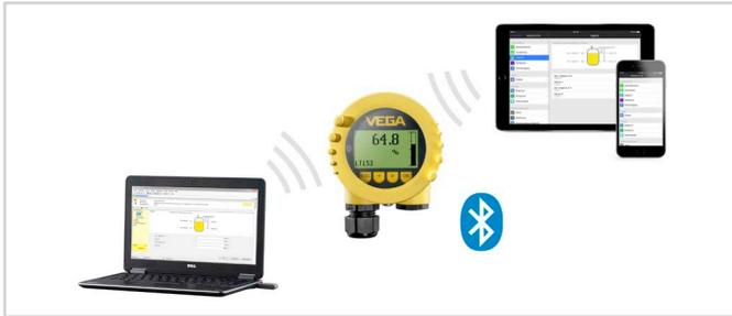
Drahtlose Verbindung zu Standard-Bediengeräten
