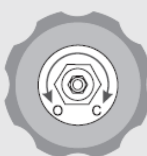
Ventil mit Handrad Öffnen gegen den Uhrzeigersinn
