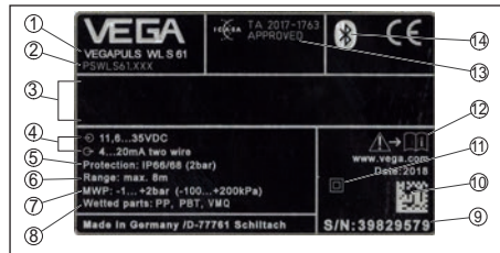
Abb. 1: Aufbau des Typschildes (Beispiel)
