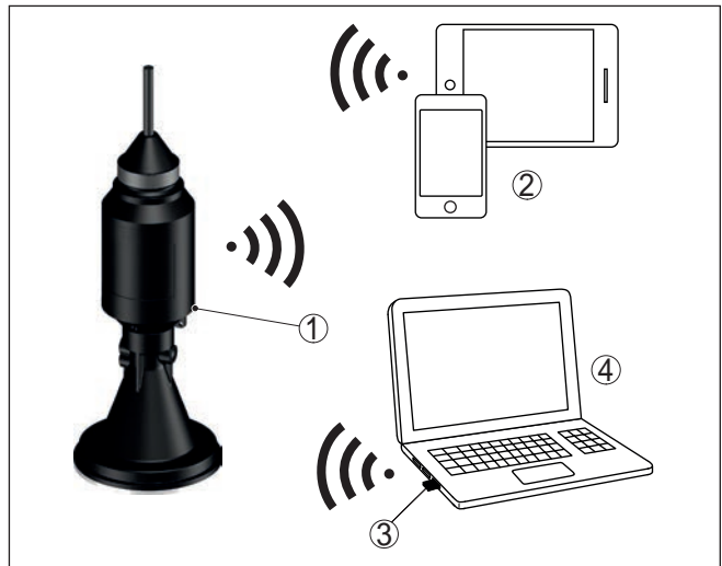
Abb. 3: Drahtlose Verbindung zu Standard-Bediengeräten
