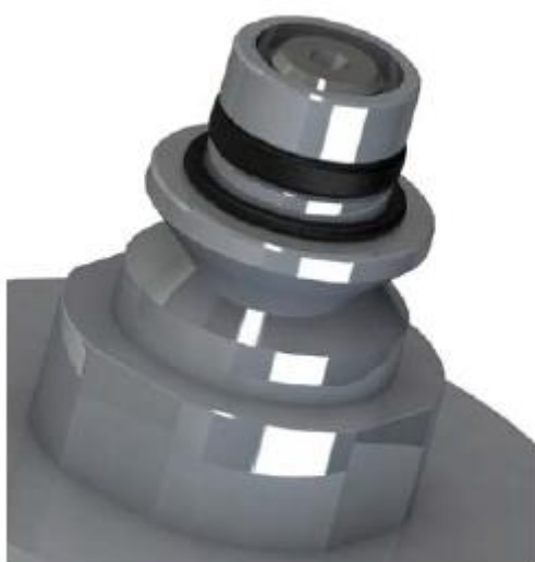
Abb. 45: Position der O-Ringe
