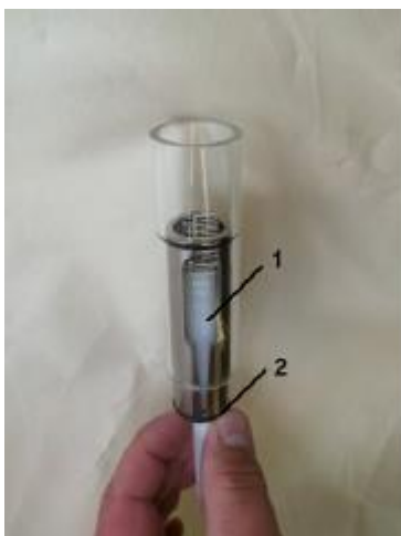
Fig. 46: Insert slot nozzle
